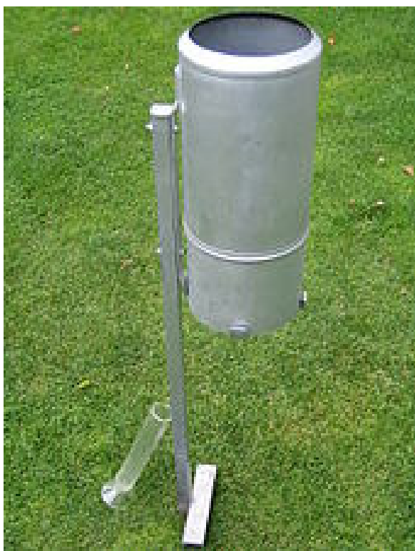
Abbildung 8 Niederschlagsmesser nach Hellmann
